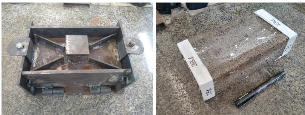
Figura 5 – Molde metálico com a tampa fechada (esquerda) e tijolo ecológico com resíduo de tecido de Poliéster (direita). (Fonte: o próprio autor)
