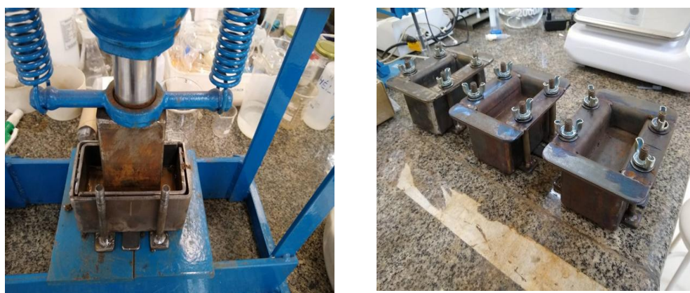
Figura 4 – Aparato de compressão (esquerda) e corpos de prova finalizados (direita)(Fonte: o próprio autor)
